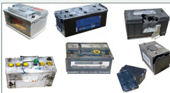
Figur 1: eksempel på lekkasjefrie blybatterier
