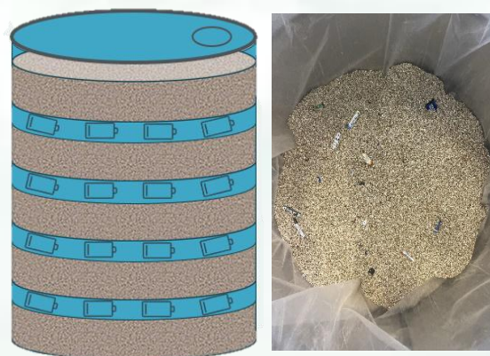
Figur 3: pakking av portable batterier i fat med vermikulitt
