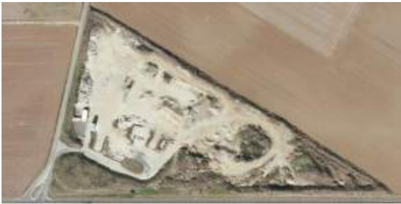
Figure 54. Situation de la parcelle entre 2011 et 2015 – broyage, criblage et transit de matériaux inertes (Source : Remonter le temps)
