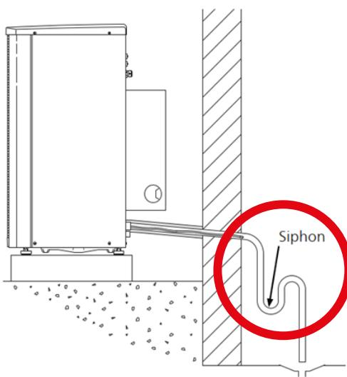
Der Kondenswasserschlauch muss über einen Siphon verfügen, der eine Luftzirkulation und damit eine Geruchsbildung im Schlauch unterbindet.
