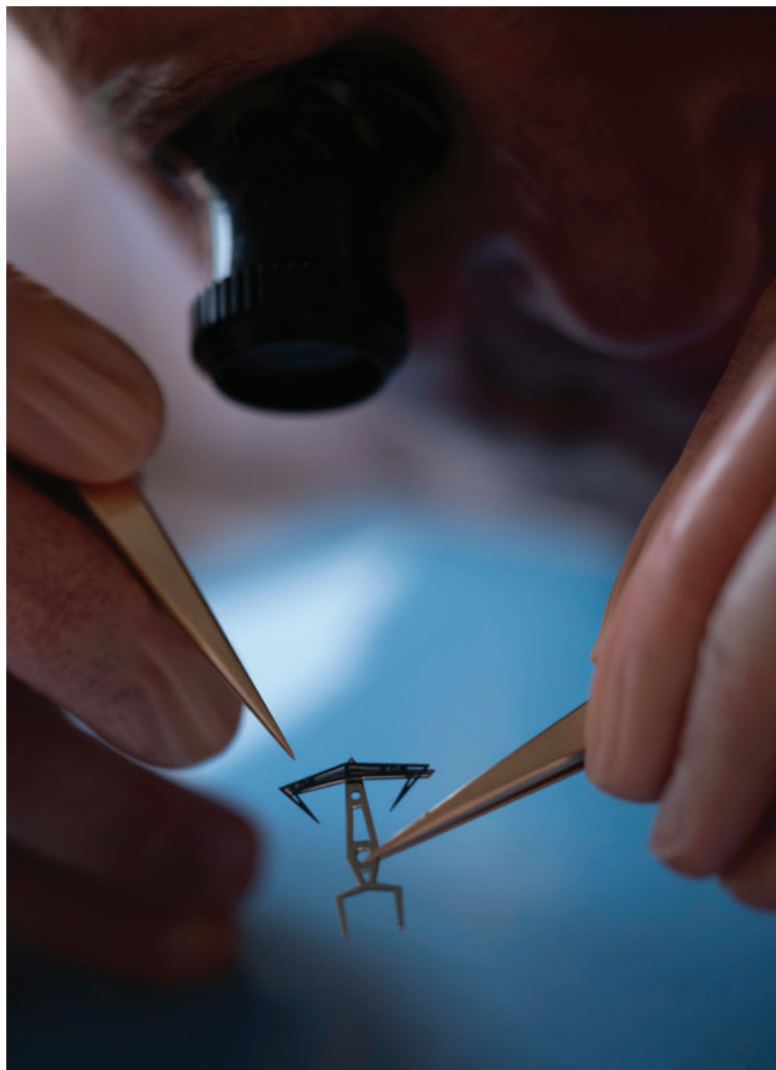
L'ancora in acciaio e silicio dello scappamento sul lato quadrante del Complication One. Mentre l'ancora sul lato movimento trasmette la frequenza, questa è l'organo che distribuisce il tempo.
