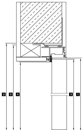
Horizontalschnitt mit stumpfem Türblatt
