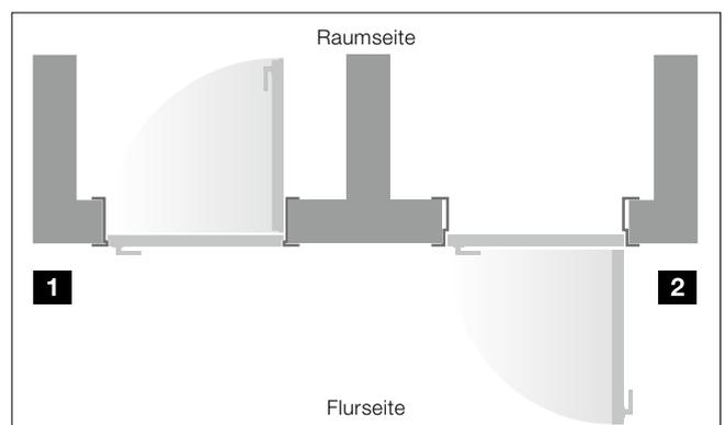
Die reverse-öffnende Tür (DIN links) öffnet in den Raum **1** und die normal öffnende stumpfe Tür (DIN rechts) öffnet in den Flur **2**.
