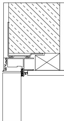
Horizontalschnitt mit stumpf einschlagender Tür
