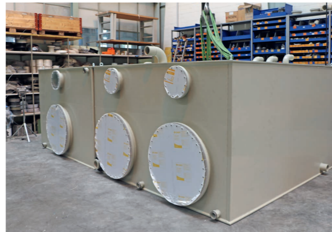
5 m 3 + 10 m 3 – PP Ausgleichstank L 3.0 x B 1.5 x H 1.5m
