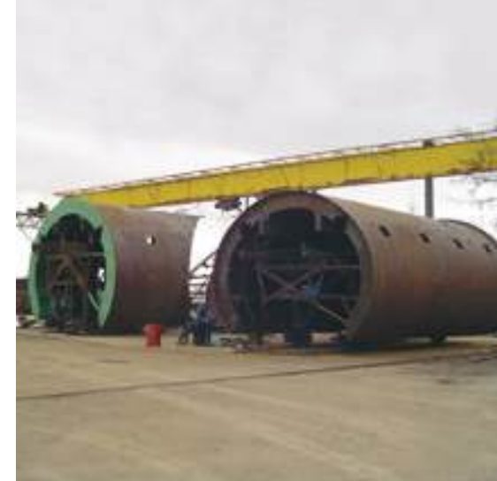
KARTAL KADIKÖY METRO İSTASYONLARI Tünel Kalıbı KARTAL KADIKÖY (İSTANBUL) SUBWAY STATIONS - Formwork
