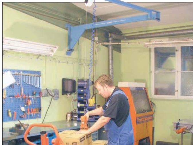
PMH Knäckarmar monterad i pelare eller väggfäste är ett smidigt hjälpmedel vid precisionsarbeten. Förses med fäste för balansblock, telfer, verktyg mm.
