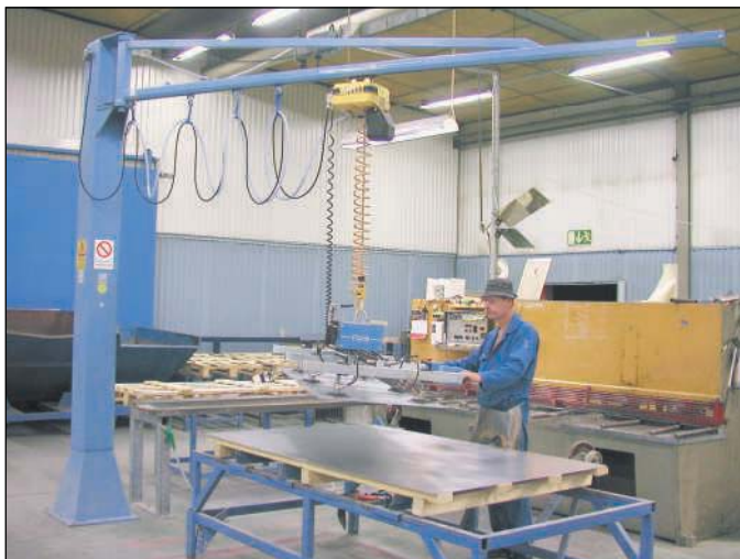
PMH Pelarsvängkranar finns med manuell eller driven svängrörelse i flera olika modeller. Pelarsvängkranen förankras direkt i betonggolvet.
