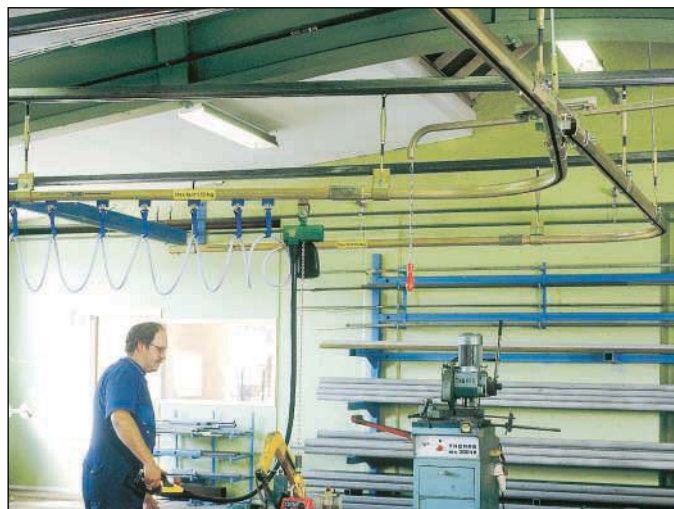
PMH Enkelbanor förflyttar effektivt en last linjärt mellan två olika punkter. Tillbehörsprogrammet är stort med bl a åkvagnar, kurvor och växlar.
