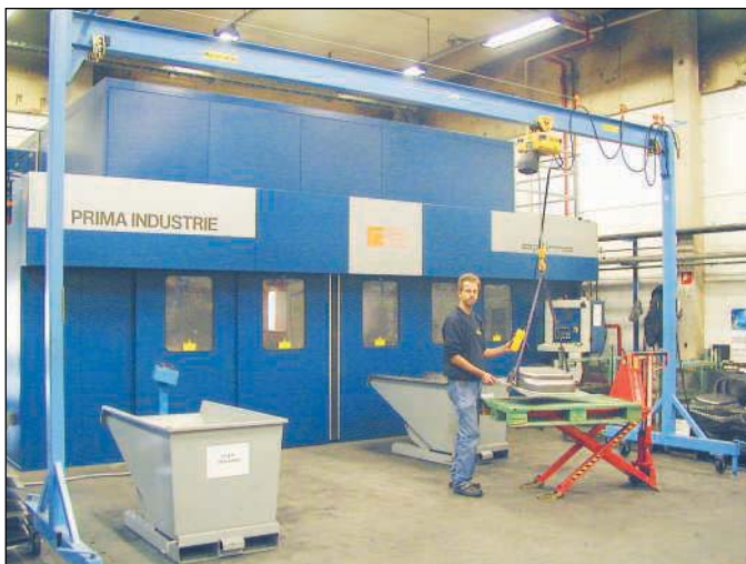
PMH Bockkranar är ett lyfthjälpmiddel vid portabla arbeten. Bockkranen monteras enkelt och är delbar i tre delar.
