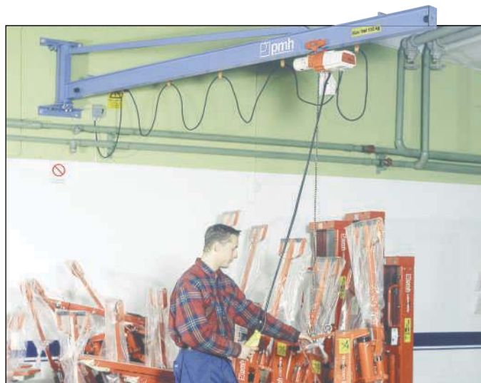
PMH Väggsvängkranar monteras runt pelare eller direkt i väggen. Svängkranens arm är uppbyggd med profilskena eller I-balk.
