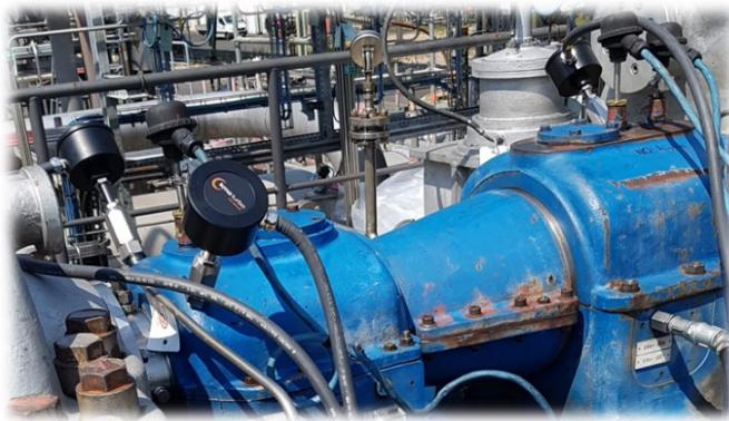
KS016 ist keine gewöhnliche Sondenhalterung. Sie ist eine vielfach bewährte Eigenentwicklung von kmo turbo für die schnelle, sichere und reproduzierbare Installation von Reverse-Mount-Wirbelstromsonden in Turbomaschinen. Sie vereinfacht Montage und Wartung deutlich, verhindert typische Schäden wie Kabelbrüche – und reduziert durch clever Standardisierung Aufwand, Variantenvielfalt und Ersatzteilkosten.
