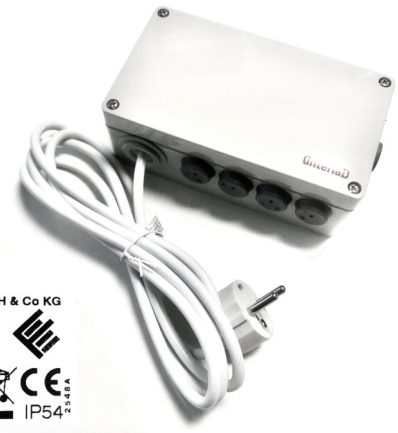
Abbildung 3: Platinenbox geschlossen mit Schuko-Anschlusskabel und rückseitigem Produktetikett mit Typenbezeichnung
