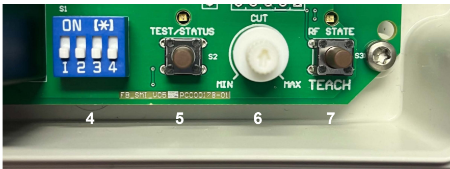
Abbildung 2: Platine mit Bedien- und Funktionselementen: (4) DIP-Schalter (5) Testtaster mit Betriebsstatus-LED (6) Drehpotentiometer (7) Einlernntaster mit Betriebsstatus-LED Funk
