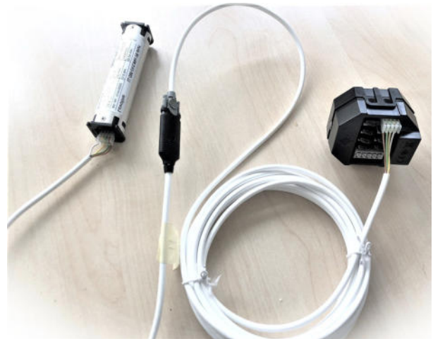
Beispiel: Anschlussreihe Motor - Stecker - Controller
