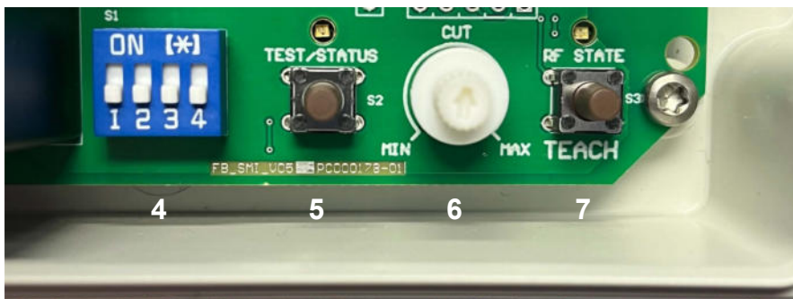
Abbildung 2: Platine mit Bedien- und Funktionselementen: (4) DIP-Schalter (5) Testtaster mit Betriebsstatus-LED (6) Drehpotentiometer (7) Einlertaster mit Betriebsstatus-LED Funk
