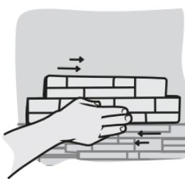
Coloca la pieza presionando uniformemente y realizando un movimiento en diferentes direcciones buscando la cobertura total del adhesivo en la superficie. Evita golpear la piedra.
