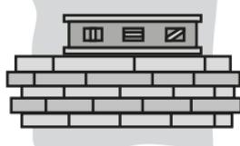
Cuida la nivelación y ve retirando cualquier exceso de adhesivo entre cada pieza para lograr una correcta apariencia.
