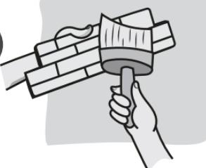
. Usa un adhesivo para baja o nula absorción. Verifica que la parte posterior de la pieza no tenga polvo antes de colocar el adhesivo. Aplica el adhesivo de manera uniforme.
