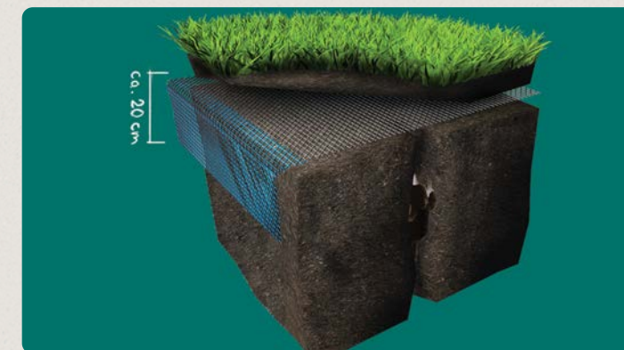
Einsatz als Oberflächenbarriere – unterbindet zuverlässig das Aufwerfen von Erdhügeln.
