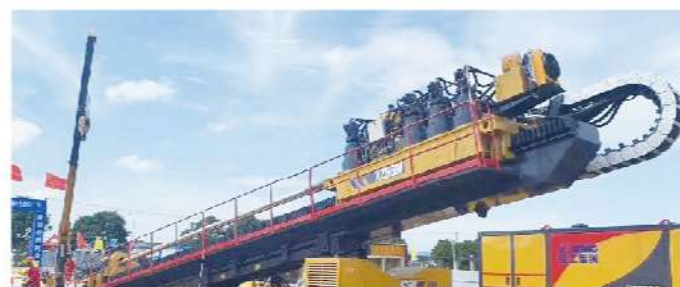
XZ6600, Oilpipeline, \Phi 813\text{mm} , 2327m
