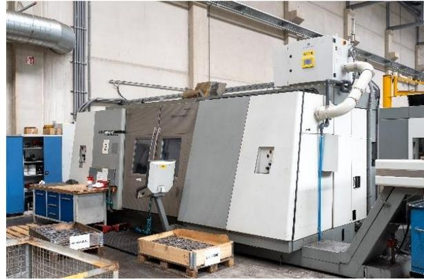
Abbildung 5: Öl-/Emulsionsnebelfilter mit leistungsstarker Glasfaser-Drainagetechnologie und Nachfilterung mittels Hepa-Filter auf der Bearbeitungsmaschine
