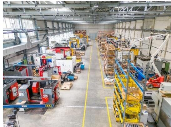
Abbildung 7: Maschinenhalle mit Wärmeableitung und Maschinenabsaugungen mit Öl-/Emulsionsnebelfilter
