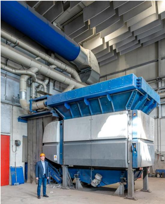
Abbildung 6: Zerkleinerer mit aufgesetztem Absaugkranz und der dazugehörigen Abluftverrohrung und zugfreier Umlufteinbringung
