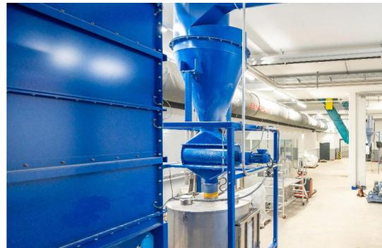
Abbildung 5: Der mit Unterdruck betriebene Mühlenkeller für das Recycling der Produktionsabfälle.
