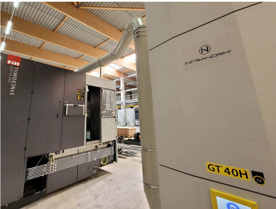
**Bild 04:** Zur Verbesserung der Hallenluftqualität wurden die neuen Bearbeitungszellen mit selbstreinigenden Filteranlagen ausgestattet.
