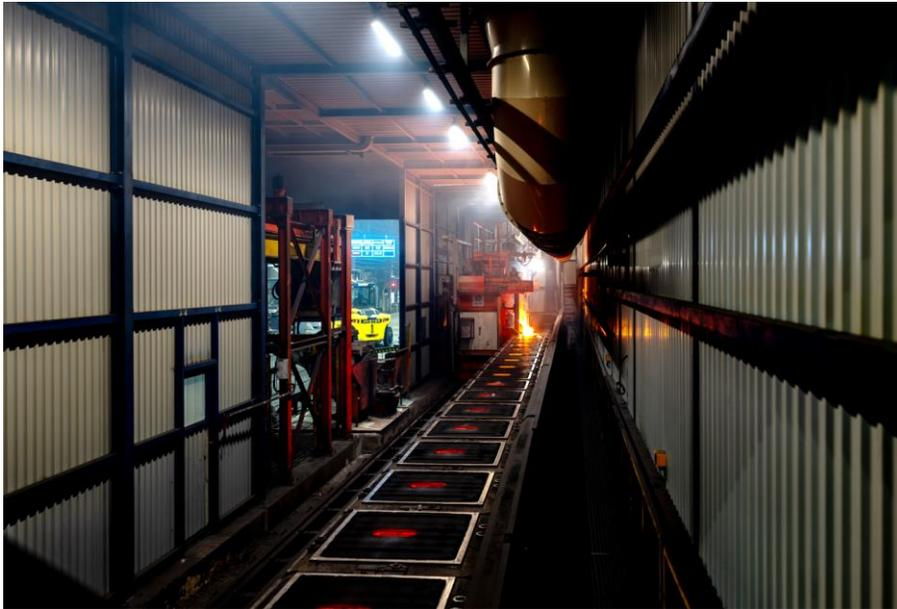
Einhausung der Gießstrecke mit zonengesteuerter Absaugung
