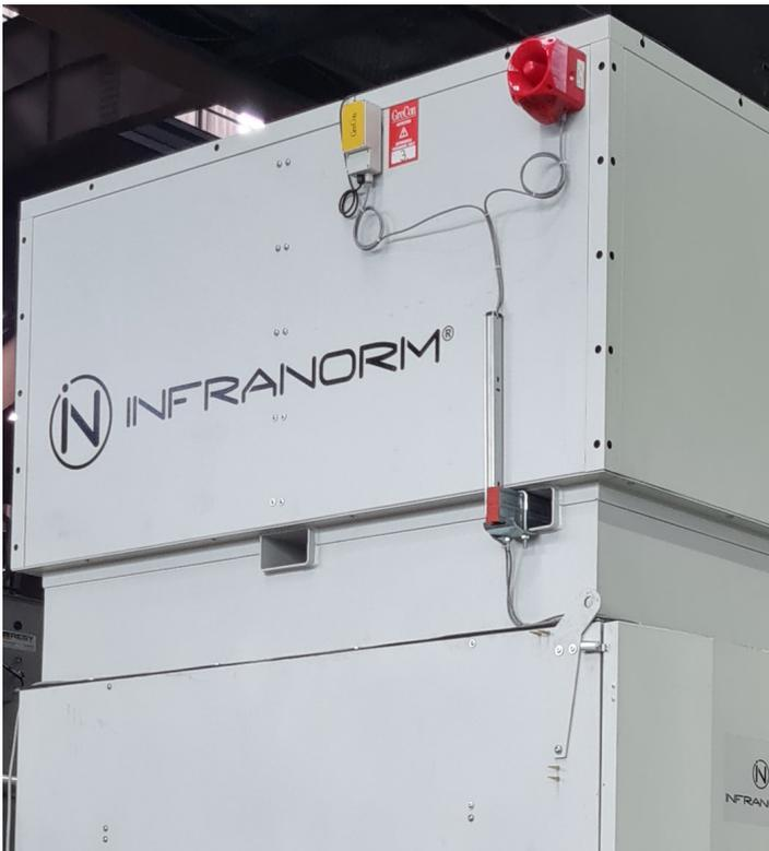
**Bild 03:** Wirtschaftliche Filteranlage mit Funkenmelder und Signalthorn zur Brandfrüherkennung
