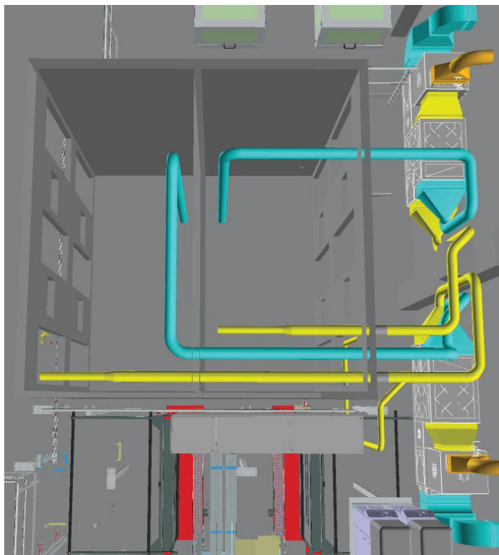
Bild 01 und 02: 3D-Visualisierung der Wärmerückgewinnungsanlage für die Papier-Trocknungslinien bei IBS Austria
