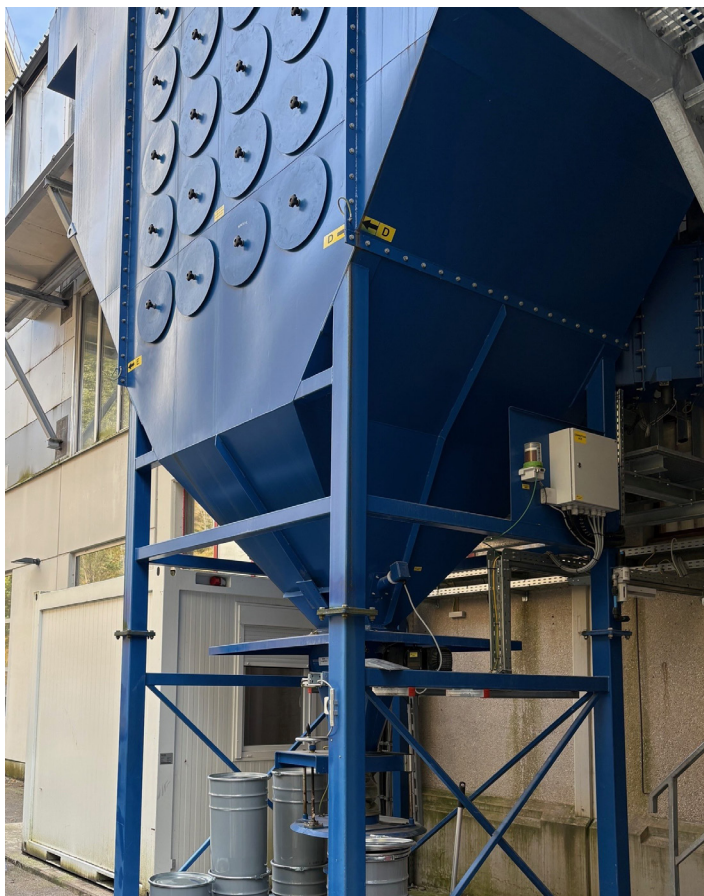
Bild 06: Filteranlage und Fassgebinde zur Ausbringung von Filtrat (Projekt 2)
