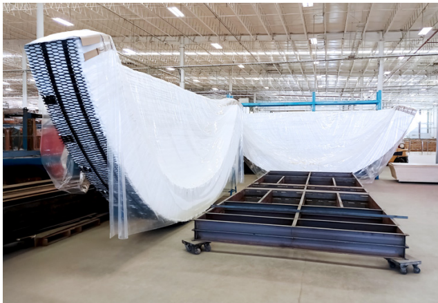
Fig. 3 El techo de este fundidor fue construido en tres secciones para facilitar el envío y la instalación
