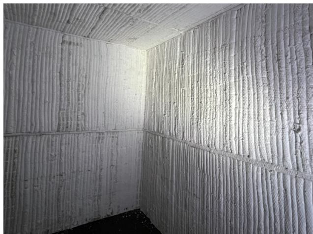
Fig.6 Dado que son más grandes que la mayoría de los módulos típicos, los módulos MaxBlock , en conjunto con los anclajes H, se instalan rápidamente y minimizan uniones en todo el sistema de aislamiento.
