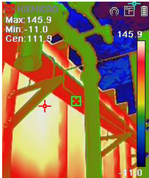
Fig.4 y 5 El uso de módulos de gran tamaño en esta aplicación producen una distribución de calor altamente uniforme a través del oxidador, como se demostró en las imágenes térmicas. Las temperaturas de la cara fría medidas son ligeramente inferiores a las predichas por el Departamento de Ingeniería de Aplicaciones de NUTEC .
