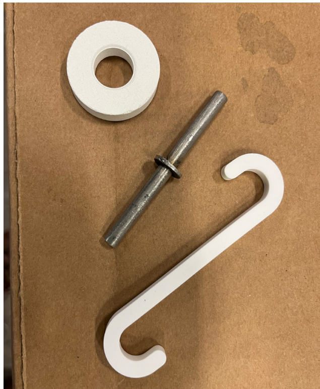
Fig. 2 Pasador Alineador, Gancho y Arandela Cerámica
