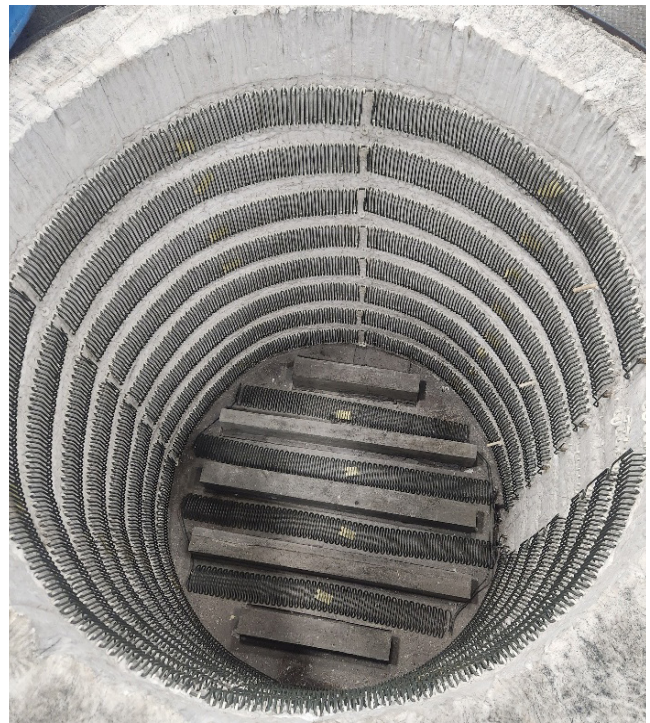
Fig.4 Módulos MaxBlock con sistema de elementos eléctricos en Horno de Foso
