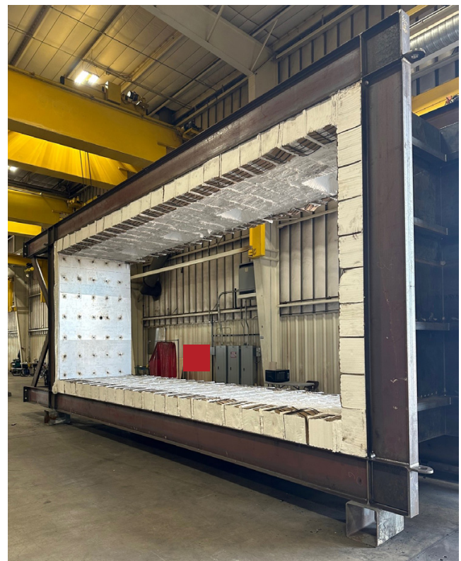
Fig.1 Con el sistema pre soldable Stud-Tite, los módulos se instalan fácilmente en el taller utilizando pernos diseñados para facilitar el montaje en campo.
