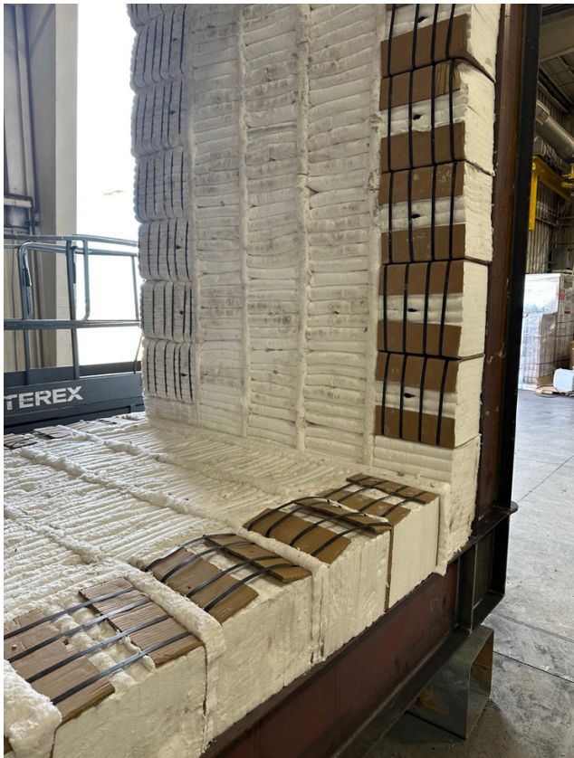
Fig.2 Para los perímetros de las secciones, generalmente se dejan en su lugar las bandas de los módulos y las tapas de cartón como medida de protección durante el transporte.
