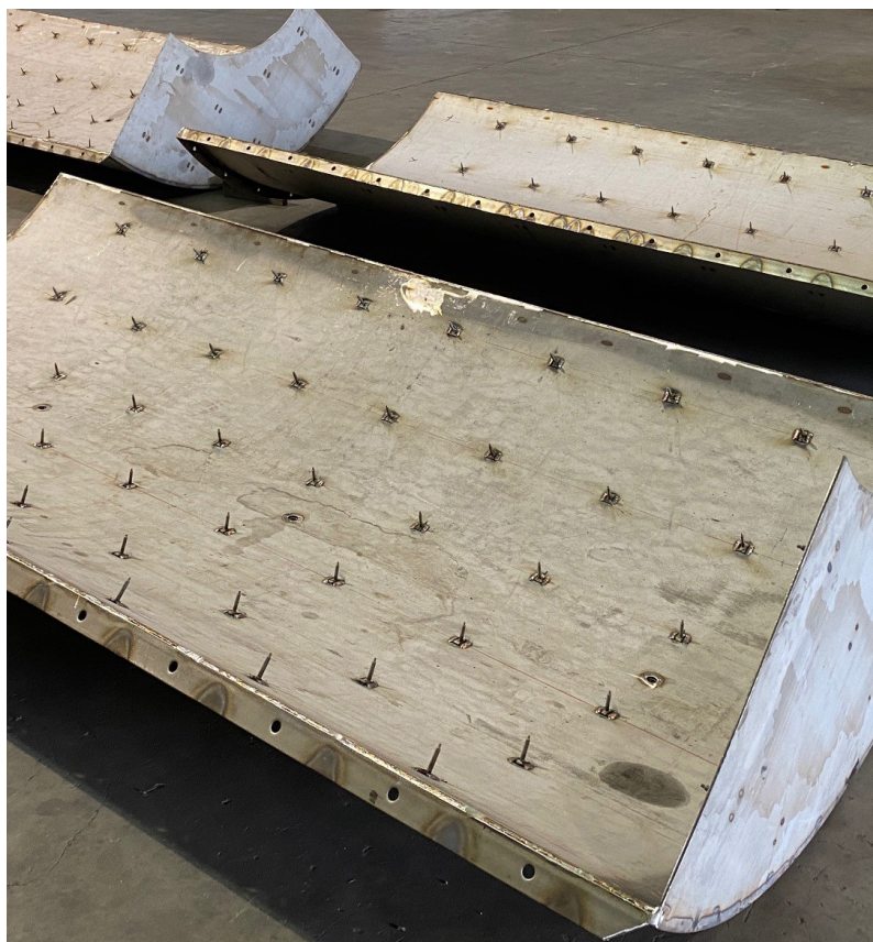
Fig.1 El sistema Stud-Tite de NUTEC fue utilizado como método de anclaje
