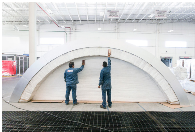
Fig. 3 MacroMódulos MaxBlock - Construcción de Panel de Techo
