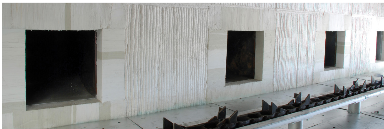
Fig.1 MacroMódulos MaxBlock - Aplicación en Horno de Acero
