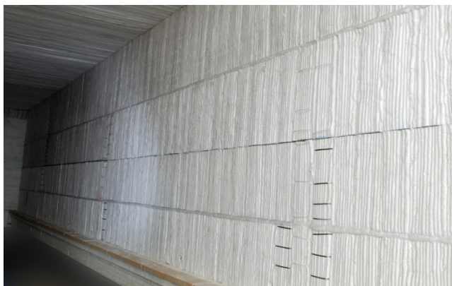
Fig. 2 MacroMódulos MaxBlock - Aplicación en Horno de Cerámica
