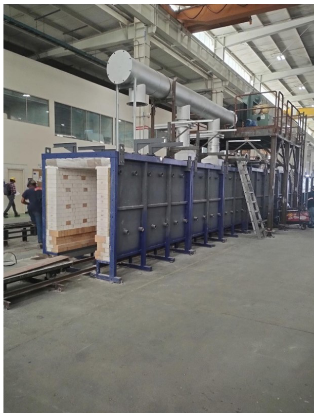
Fig. 2 Antes del envío, el horno se ensambla por completo y luego se desmonta, asegurando y protegiendo sus componentes para su transporte a las instalaciones del usuario final.
