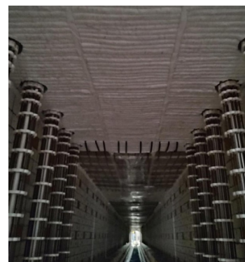
Fig. 3 Los módulos Stud-Tite se extienden a lo largo de los muros laterales revestidos de ladrillo y permiten la inserción de los elementos calefactores verticales de carburo de silicio, suspendidos desde el techo del horno.
