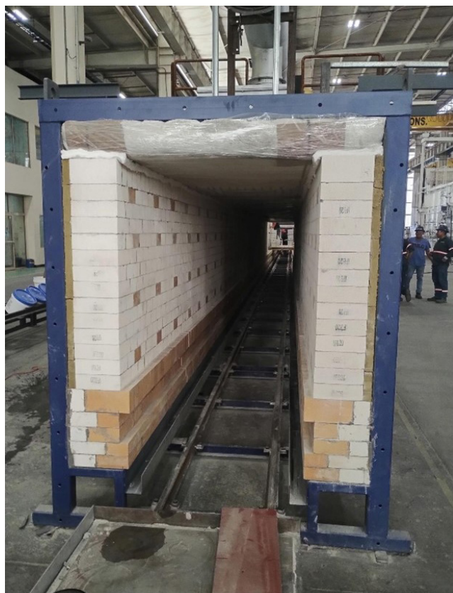
Fig. 2 Antes del envío, el horno se ensambla por completo y luego se desmonta, asegurando y protegiendo sus componentes para su transporte a las instalaciones del usuario final.
