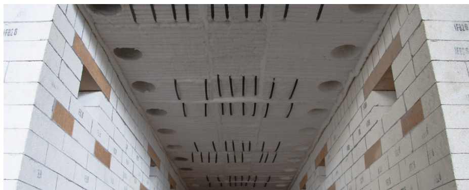
Fig. 3 Los módulos Stud-Tite se extienden a lo largo de los muros laterales revestidos de ladrillo y permiten la inserción de los elementos calefactores verticales de carburo de silicio, suspendidos desde el techo del horno.
