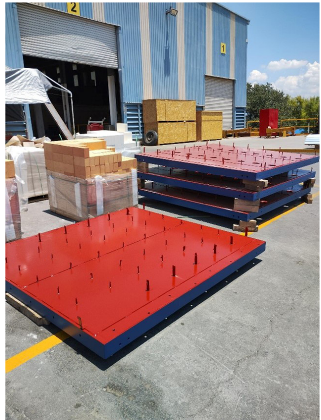
Fig.1 Los paneles de acero para el techo del horno fueron soldados con pernos Stud-Tite y posteriormente se les aplicó el recubrimiento protector para la carcasa del horno.
