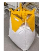
Storsäcksok med tyngd för säckar med mycket låg vikt som ska skäras
