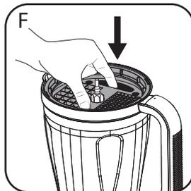
**Importante:** Coloque siempre el extremo curvo de la cuchilla debajo del labio del disco de corte PRIMERO y, a continuación, coloque el centro de la cuchilla en el eje central del disco.
