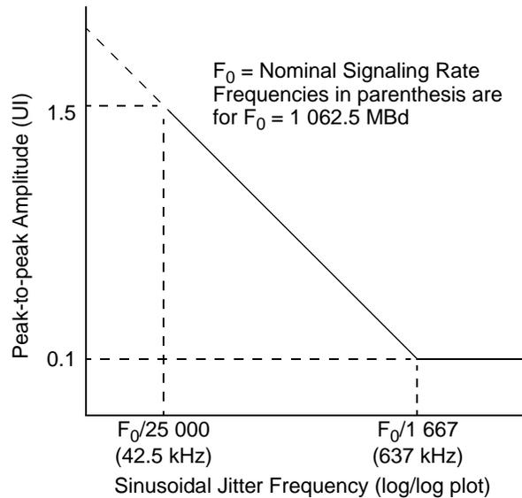
**Figure 44 – Sinusoidal jitter mask**
