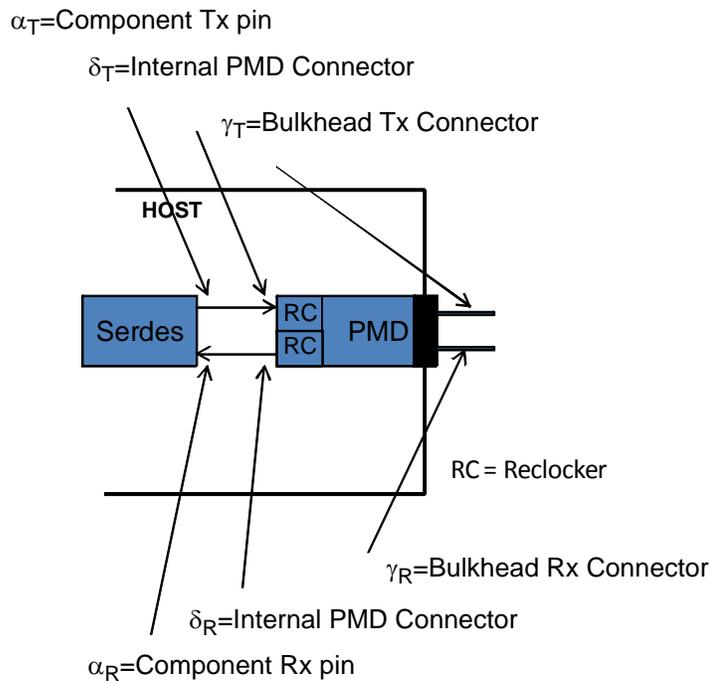
**Figure 8 – reclocker location for 1600-M5-SN-S, 1600-M5E-SN-I and 1600-M5F-SN-I**
