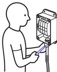
b. Passez les câbles du fourreau annelé dans le boîtier via le presse-étoupe. **Assurez un serrage correct et une parfaite étanchéité.**
