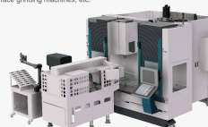
前置式交換工作站 Front feeding workstation
