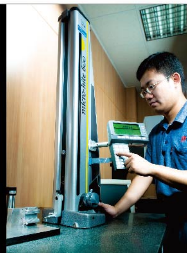
瑞士TESA 電子式高度規 ▲ Swiss TESA electronic type height gauge
