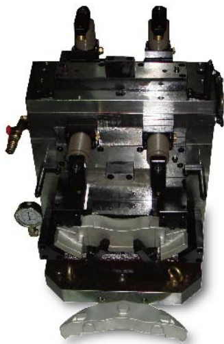
AP-A05 汽車卡鉗臥式油壓治具 Hydraulic jig for automotive clamp
