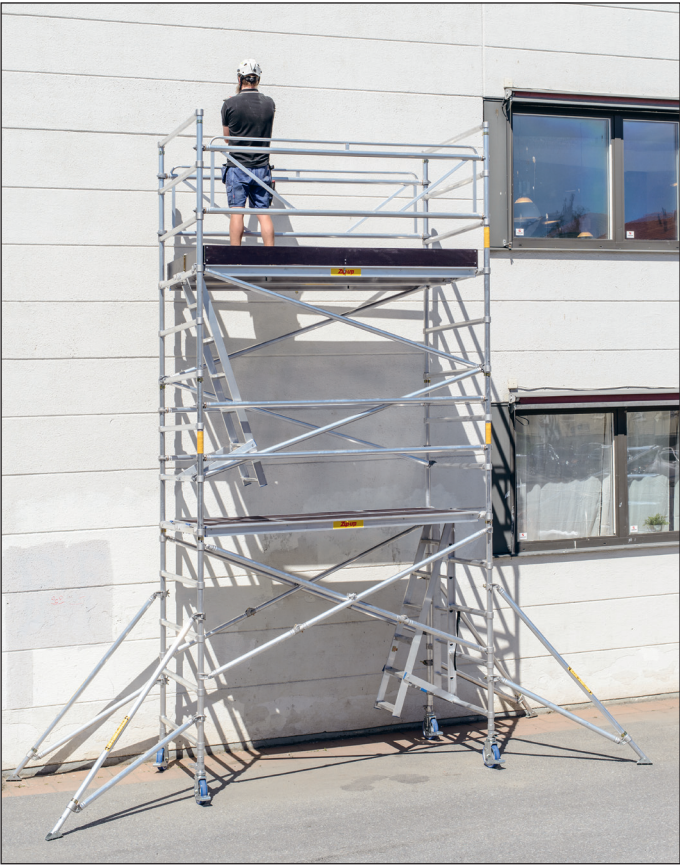
Spann 130 VX är en ställning med en stor, rejäl plattform. Spann 130 VX används främst när krav på hög höjd och stabilitet finns. Standardbasmått 1,30 x 2,0 m samt 1,30 x 2,5 m.
