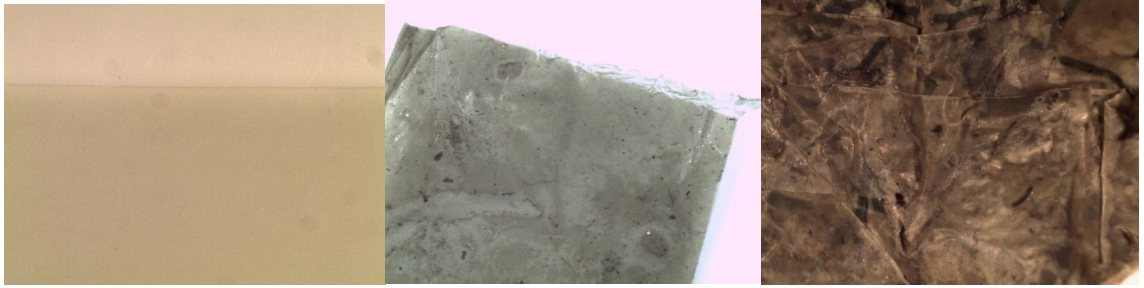
Kuva 3.9. Näyte 7 ennen mädätystä ja kompostia (vasen), mädätyksen jälkeen (keskellä) ja kompostin jälkeen (oikealla).
