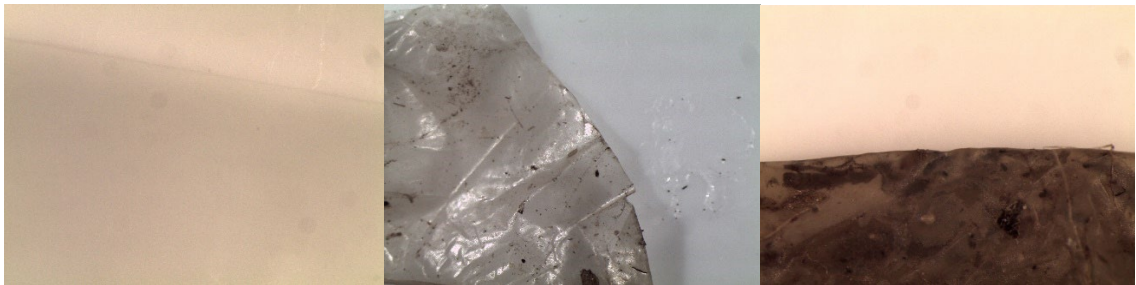
Kuva 3.4. Näyte 2 ennen mädätystä ja kompostia (vasen), mädätyksen jälkeen (keskellä) ja kompostin jälkeen (oikealla).
