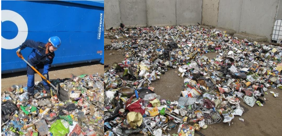
Kuva 5. Näytteenotto pistemäisenä satunnaisotantana tasatusta kuormasta. Kuva:VTT
