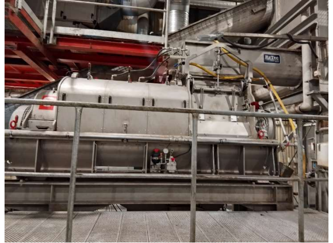
Kuva 12. Retecin toimittama Smicon vasaramylly.
