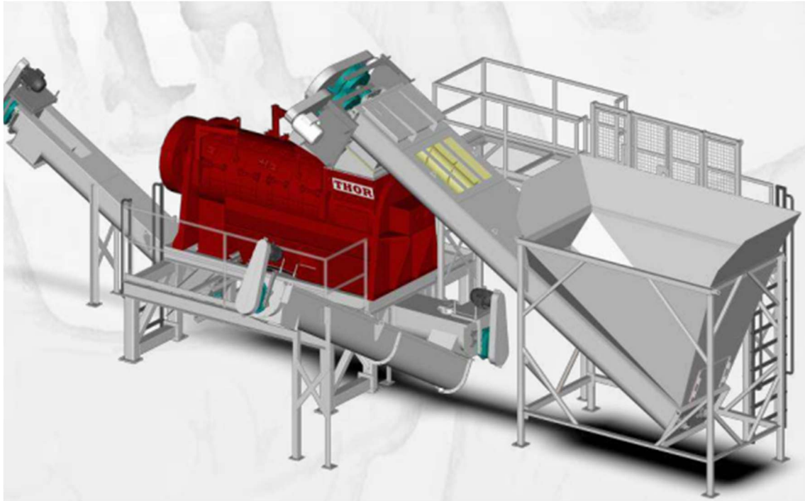
Kuva 13. Scott Equipment Company Thor Separator -laitteisto 52 .
