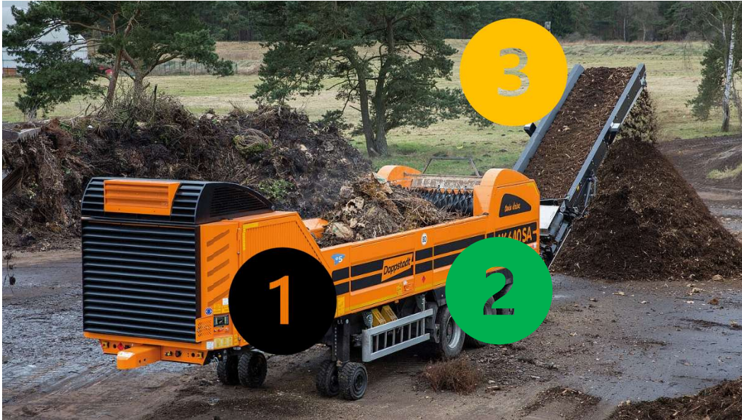
Kuva 22. Silppurilaitteisto, jossa on raaka-aineensyöttö (1), silppuri (2) sekä silputun raaka-aineen poistolinja (3) (mukaiillen (Doppstadt, 2025)).
