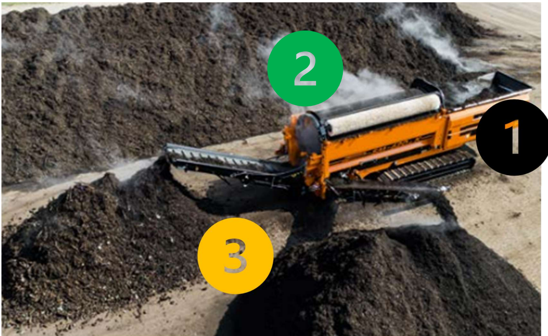
Kuva 21. Doppstadt rumpuseula -laitteisto 66 , jossa raaka-aineen syöttö (1), rumpuseula (2), rejektinä muodostunut kuitupitoinen jätemassa vasemmalla sekä seulottu kompostoitava materiaali oikealla (3).
