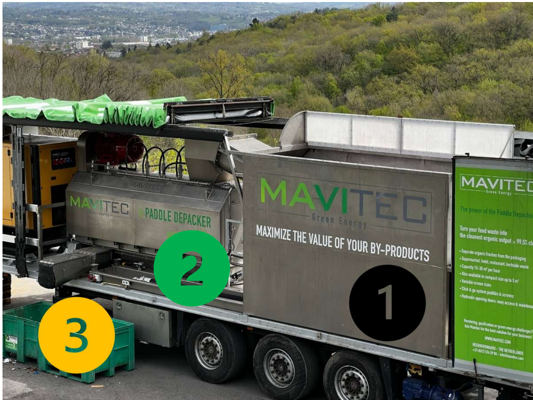
Kuva 10. Mavitec Paddle Depacker 2.0 esikäsittelylaitteisto, jossa on raaka-aineensyöttö (1), murskain ja seula (2) sekä rejektin poistolinja (3) (mukaillen (Mavitec, 2025)).
