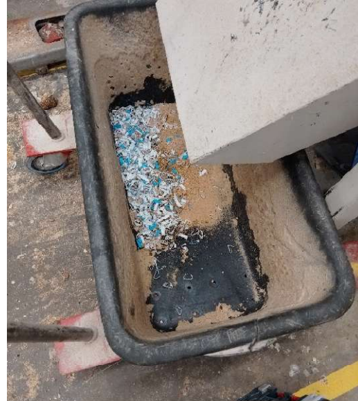
Kuva 11. Magneetilla erotettuja pussinsulkijoita.
