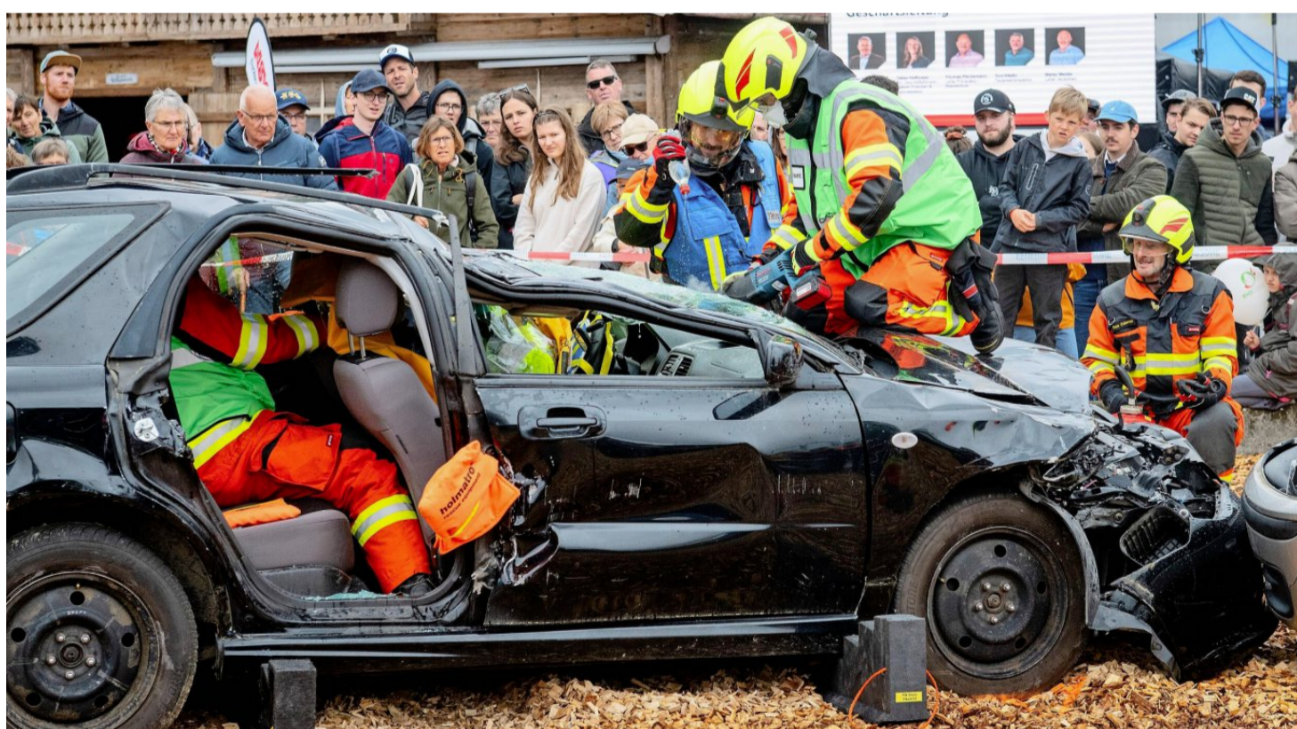
Um die verletzte Person zu bergen, wird die Frontscheibe entfernt.
