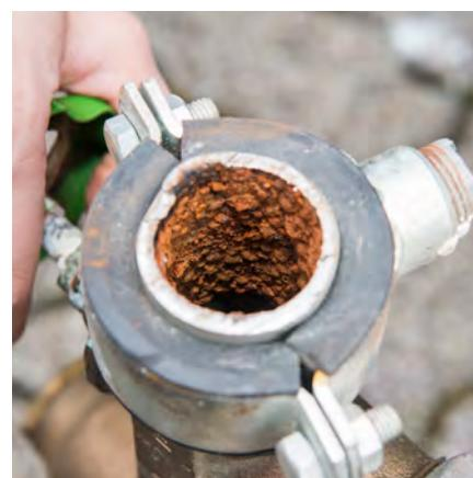
schreiben Nr. 165 vom 5. Juli 2012 betreffend die Rohrinnensanierung von Trinkwasserleitungen in Hausinstallationen und untersucht sämtliche relevanten Trinkwasserparameter. Je nach Gebäudetyp wird eine endoskopische Untersuchung durchgeführt, und es werden Rohrprüflinge entnommen, welche anschliessend bei der Naef GROUP intern untersucht werden und Aufschluss über den Handlungsbedarf geben.
