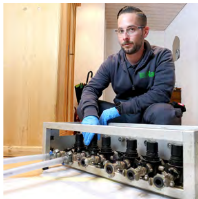
Gerätschaften für die Sanierung mit dem HAT-System / Mitarbeiter beim Sandstrahlen und anschließenden Beschichten der Leitungen
