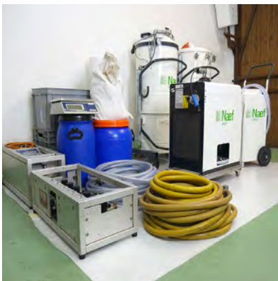
Gerätschaften für die Sanierung mit dem HAT-System / Mitarbeiter beim Sandstrahlen und anschließenden Beschichten der Leitungen
