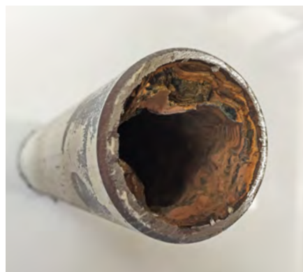
Tuyau corrodé et incrusté de dépôts calcaires
