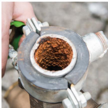
d'eau potable par l'intérieur dans les installations domestiques et examine tous les paramètres pertinents de l'eau potable. En fonction du type de bâtiment, un examen endoscopique est réalisé: des échantillons de conduites sont prélevés et analysés en interne par Naef GROUP pour renseigner sur les besoins d'intervention.
