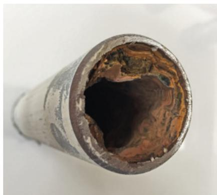
Tuyau corrodé et incrusté de dépôts calcaires
