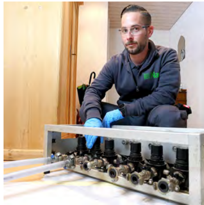
Machines pour l'assainissement avec le HAT-System / Collaborateur en train de sabler et qui, ensuite, procédera à l'injection des serpents.
