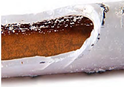
I tubi del riscaldamento a pavimento installati tra il 1970 e il 1990 sono solitamente realizzati in semplice plastica e, nel corso degli anni, diventano fragili e incrostanti a causa di fattori esterni. Se questo è il vostro caso e se il risanamento secondo l'HAT-System è ancora fattibile, lo si può determinare tramite un'analisi completa e affidabile della situazione.
