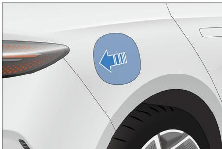
2. Öffnen Sie die Ladeanschlussklappe und vergewissern Sie sich, dass sich zwischen dem Kopf des Ladesteckers und dem Ende der Ladebuchse keine Hindernisse befinden.
