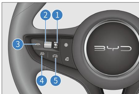
Sie den Hebel(2) nach oben, um zur gespeicherten Geschwindigkeit vor dem Verlassen des Geschwindigkeitsreglers zurückzukehren.
