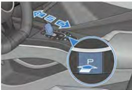
In „P“ schalten und Feststellbremse betätigen
