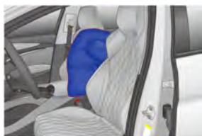
Der Fahrersitz verfügt neben dem Seitenairbag über einen hinteren-Airbag. Die Position des Far-Side-Airbags ist in der Markierung 9 auf Seite 1 dargestellt.
